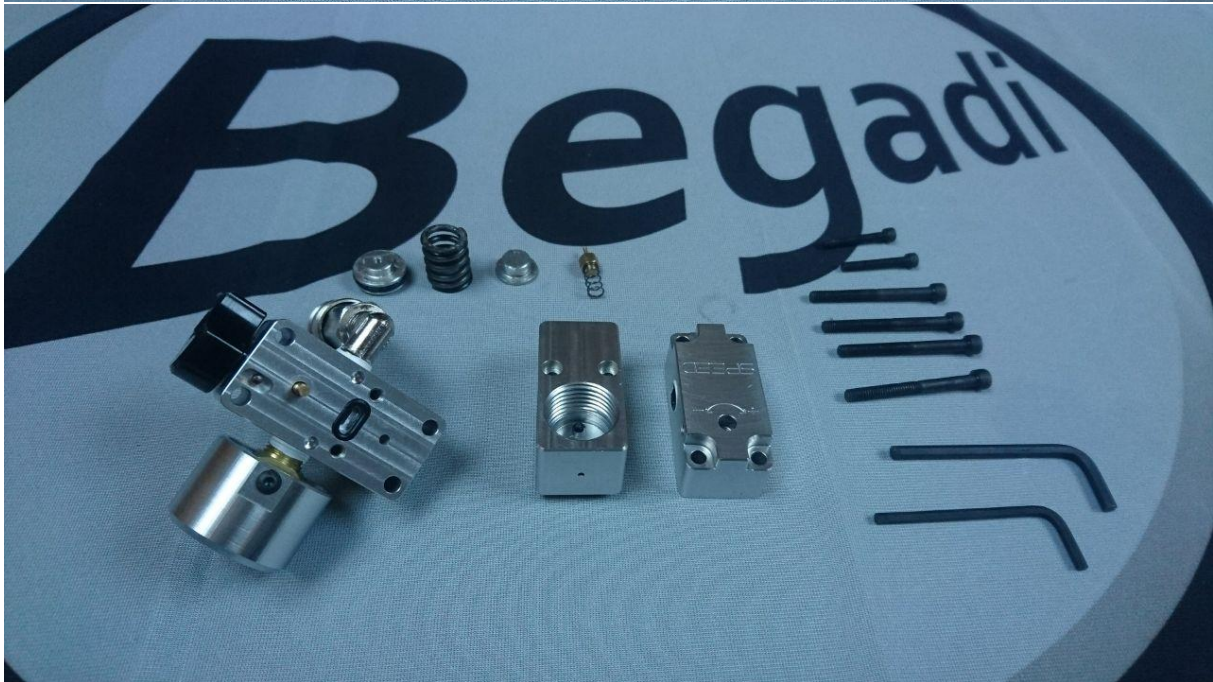
Abbildung 3 und 4: Der Regulator im zerlegten Zustand
